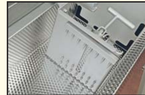
MONTAJE DE LA BASE DE EMPUJE DEL PRODUCTO
